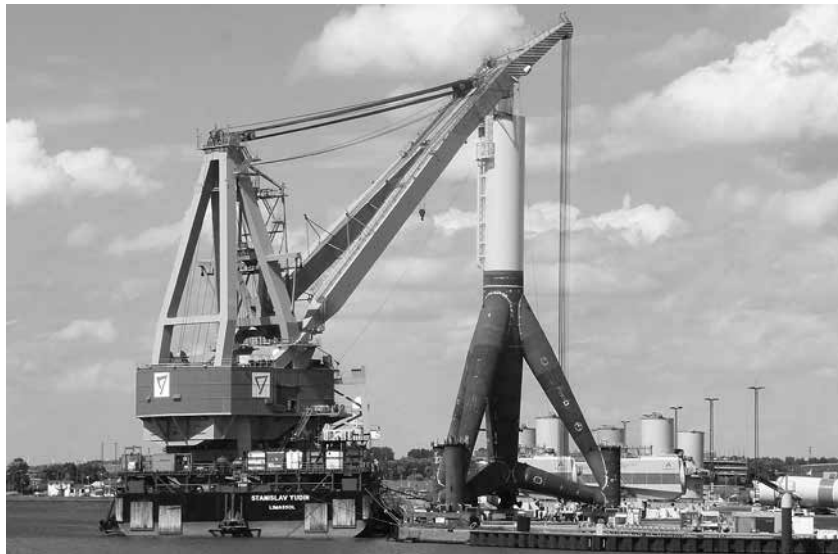
Der Kran der „Stanislaw Yudin“ kann Lasten mit einem Gewicht von bis zu 2500 Tonnen heben
